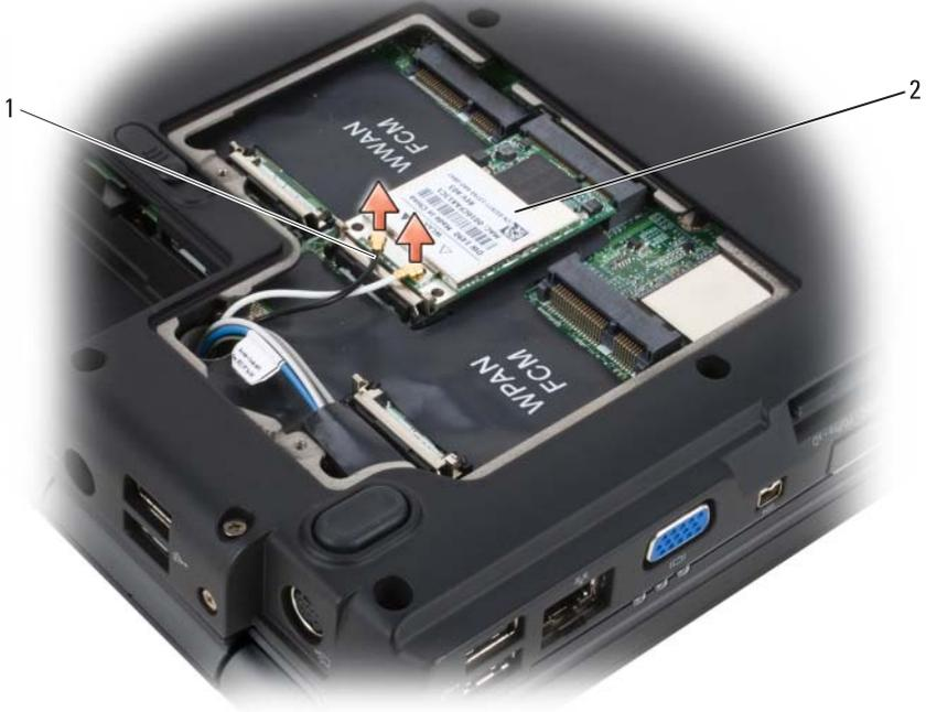
1 فتحات توصيل كبل الهوائي (2) 2 بطاقة WLAN
